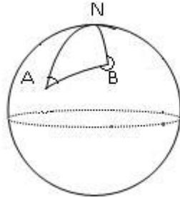
El rumbo inicial para ir de A a B se corresponde con el ángulo en A del triángulo esférico. Sin embargo para ir de B a A el rumbo inicial será:  $360^\circ - B$
